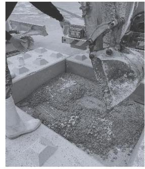
写真-1 粒状化再生骨材の製造方法
