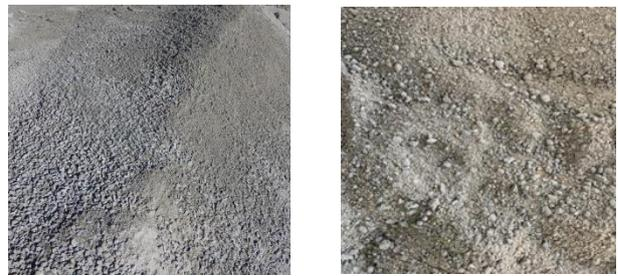
写真-1 粒状化再生骨材の一例
