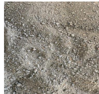
写真-1 粒状化再生骨材の一例
